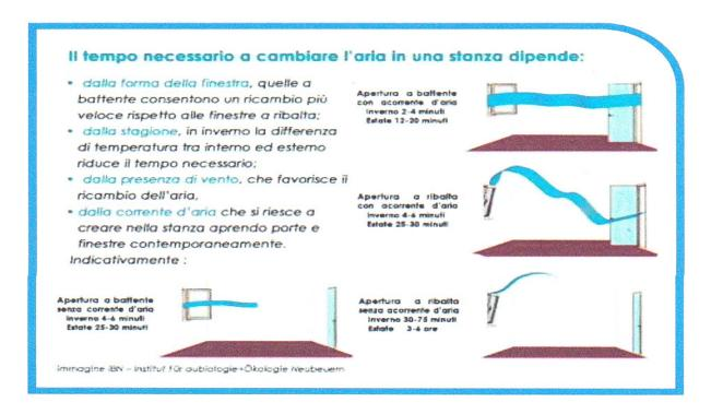
In sostanza, a seconda delle condizioni di arieggiamento (porta aula aperta o chiusa e finestre corridoio aperte o chiuse), si possono determinare tre diverse modalità di areazione delle aule:
